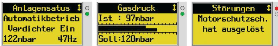
Bild 7: Statusanzeige der Steuerung
